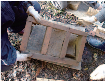
土ブロックを型枠から抜くには、型枠の角を敷き板に打ち付け、その振動で隙間を空けて抜いていくのが効率的だ。レンガ一個の大きさは、115x215x85mm。
