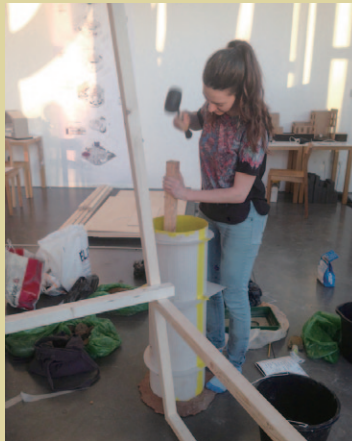
版築で土壁のサンプルを制作する
