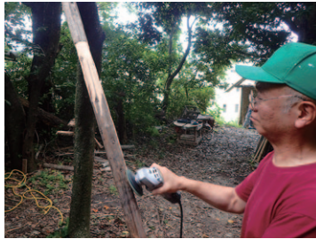
丸太が竹に入るように、少し細くする。
