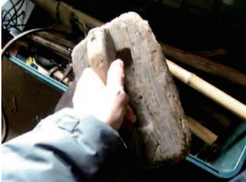
親方手づくりのガンギ。茅の端を叩きそろえて押し込む道具で、地域によって呼名が異なる。
